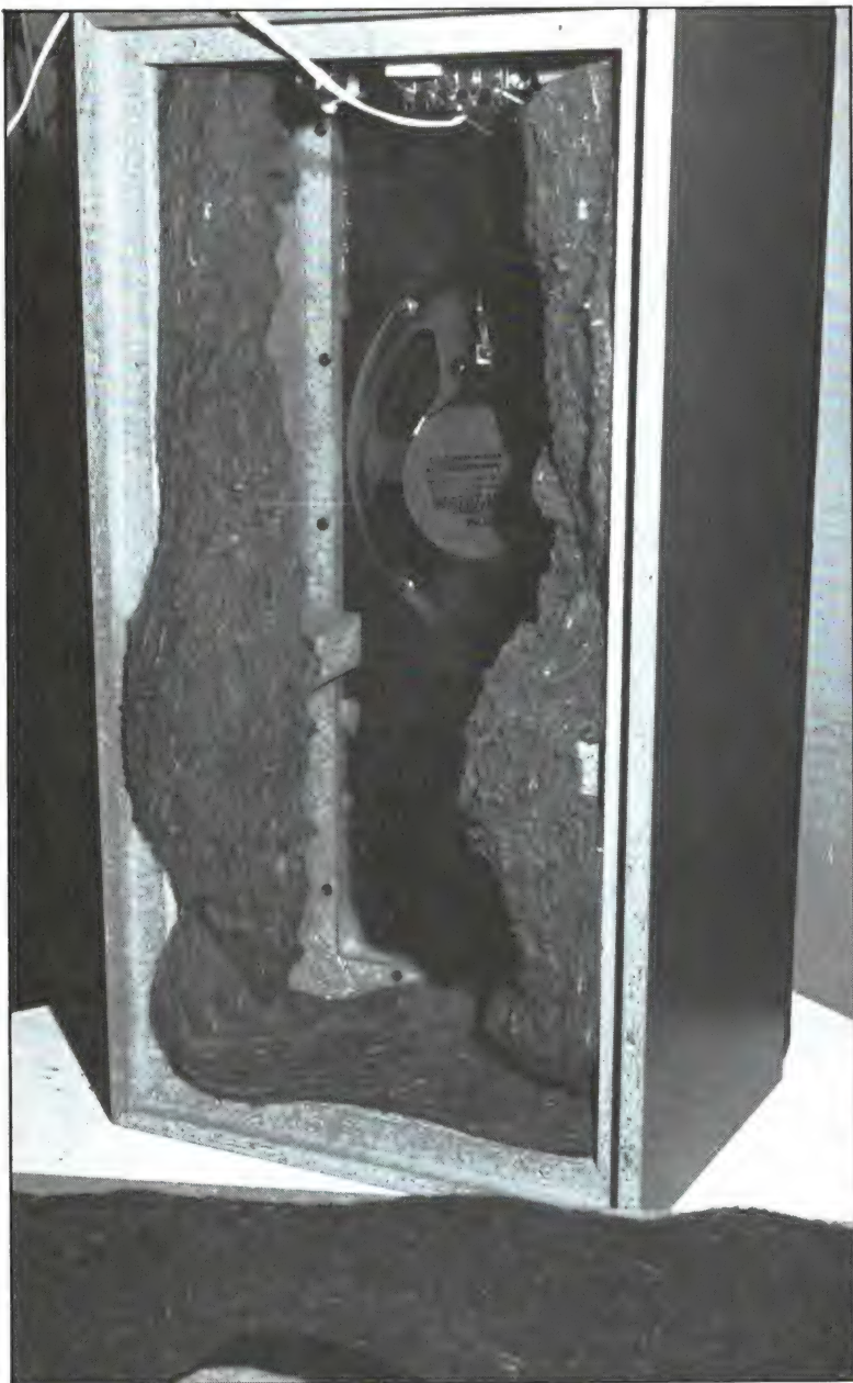
Afb. 2. De kast is opengemaakt. Er is spaanplaat van slechts 10 mm dikte gebruikt en de aanwezige tapijtwoldemping is veel te gering. De invloed ervan is niet of nauwelijks merkbaar.
